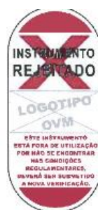
Figura 2 – Etiqueta de instrumento rejeitado
