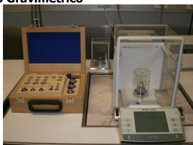
Comparador de massa de alcance máximo de 20 g e respetivas massas padrão E2
