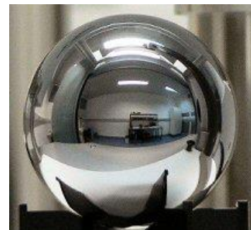
Esfera de silício – Padrão utilizado na determinação da massa volúmica de sólidos.
