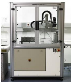
Comparador de massa robótico. Resolução: 0,1 µg. Intervalo de medição de trabalho: 1 mg a 5 g
