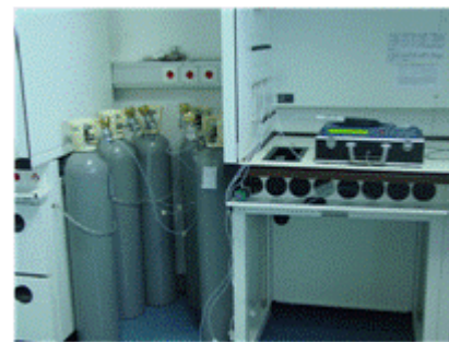
Controlo metrológico de um Alcoolímetro Evidencial
